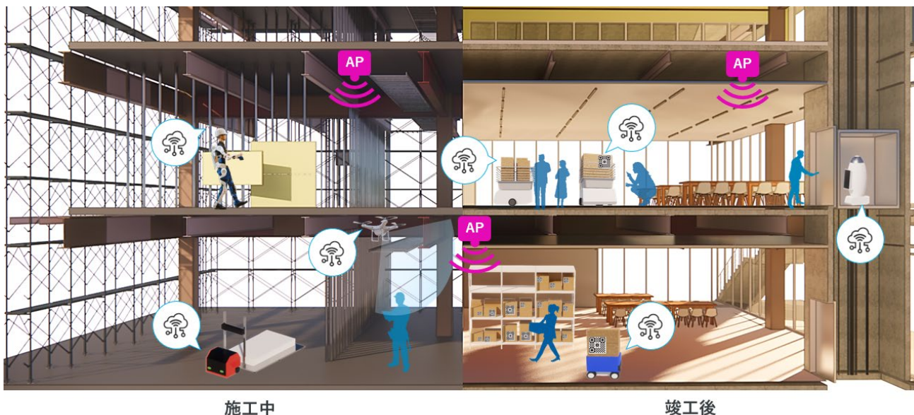
建設工事中の現場、および竣工後の建物で人協調型ロボティクスを活用するイメージ
