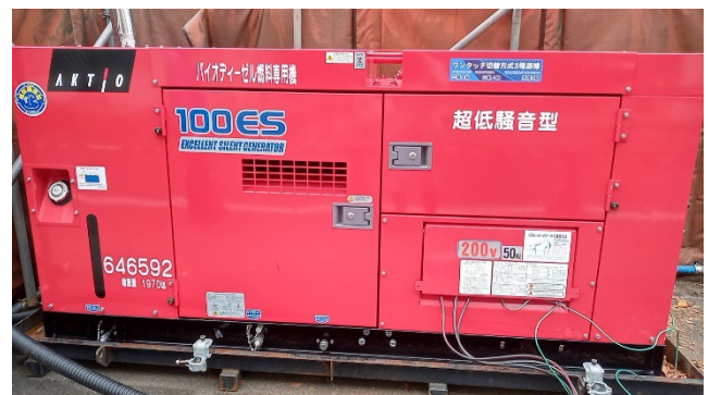
【発電容量 80KVA での B100 燃料使用開始】
