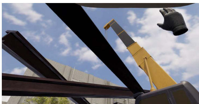
(左)「建設機械・クレーン等災害」つり荷の落下 (右)「崩壊・倒壊災害」ボックスカルバート型枠の崩壊 【体験者が実際に視認するVR空間内の映像】
