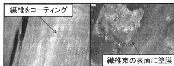
図 4 破壊後継手部界面の状況 (左: HPR-A, 右: HPR-B)
