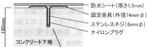
図 5 防水シートの固定部
