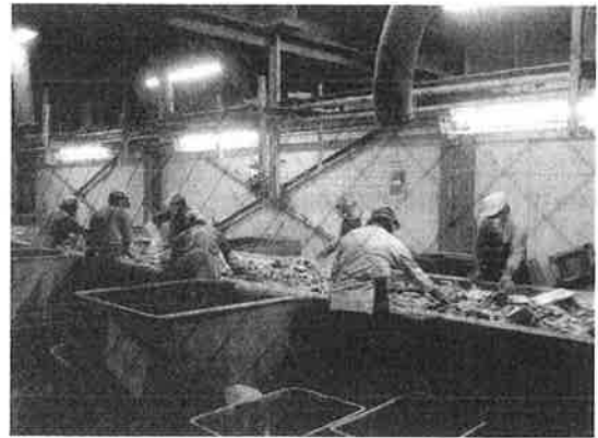
写真2 廃棄物中間処理場における手選別作業
