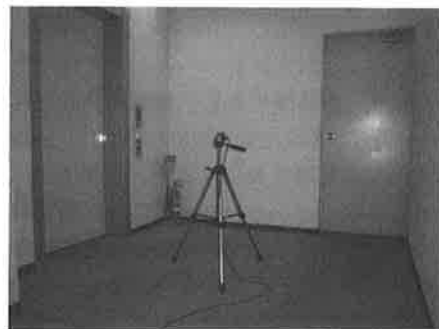
写真 1 ELV2 の磁場変動測定状況
