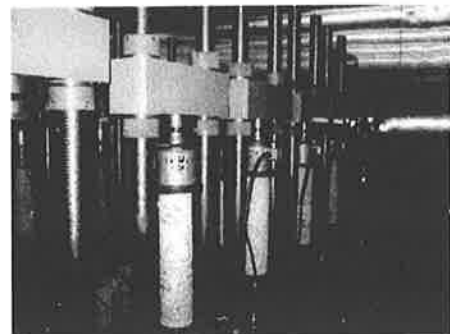
写真1 圧縮クリープ試験状況
