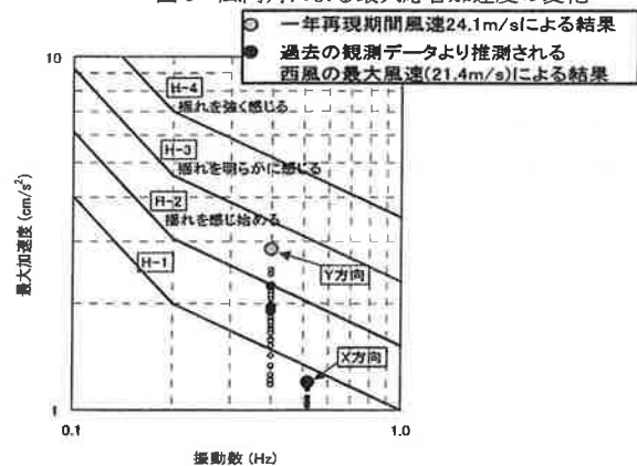
図 4 最大応答加速度の居住性能指針との比較
