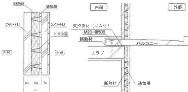
図2 PCパネル断面
