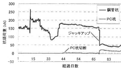
(d) 杭頭荷重 No.4 (南東)
