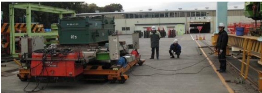
写真 3 : 横移動装置試験状況
