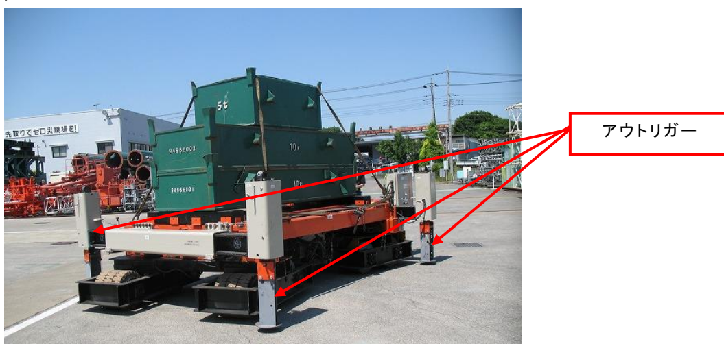
写真2：アウトリガーによる運搬台車浮揚
