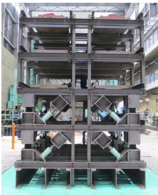
大型振動台に設置された4層鋼構造試験体
